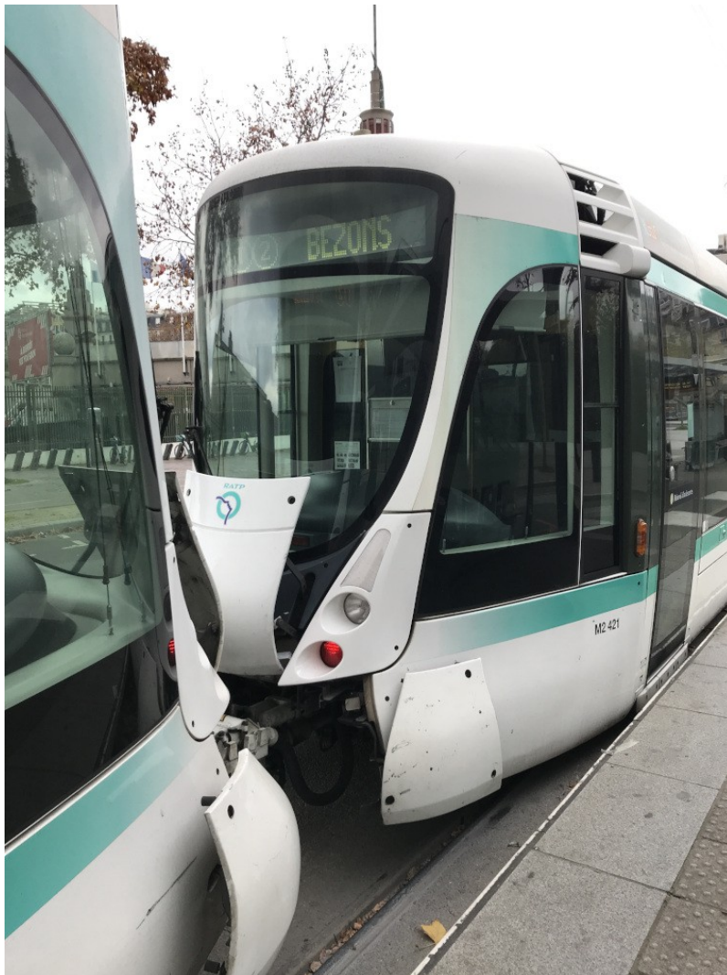
Tramways d'Ile de France, ligne 2, terminus Porte de Versailles, accouplement de deux unités.
