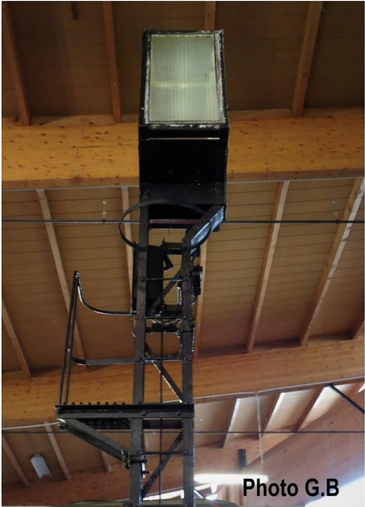
Sémaphore de block P.D. sauvegardé et présenté à la cité du train à Mulhouse, dans son état d'origine les barreaux de de l'échelle d'accès à la plateforme font partie de la structure du mâts.
