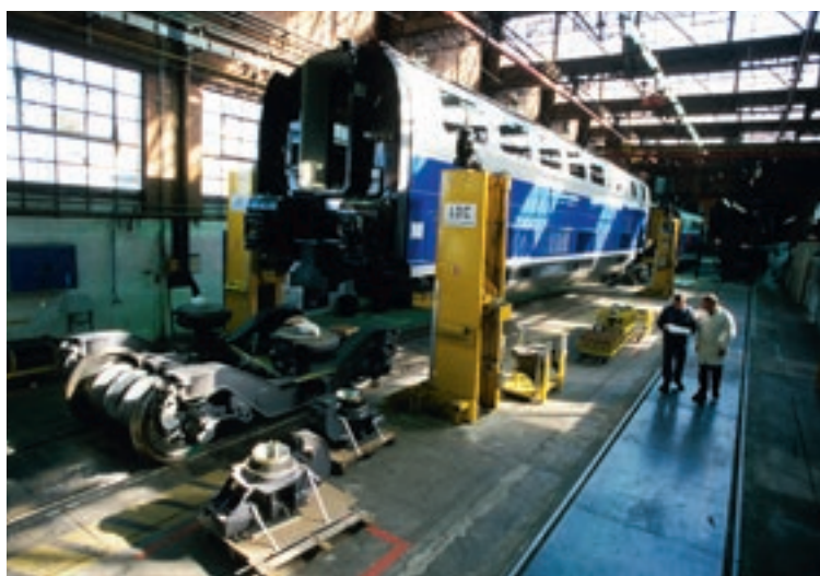
Montage d'une rame de TGV Duplex.
