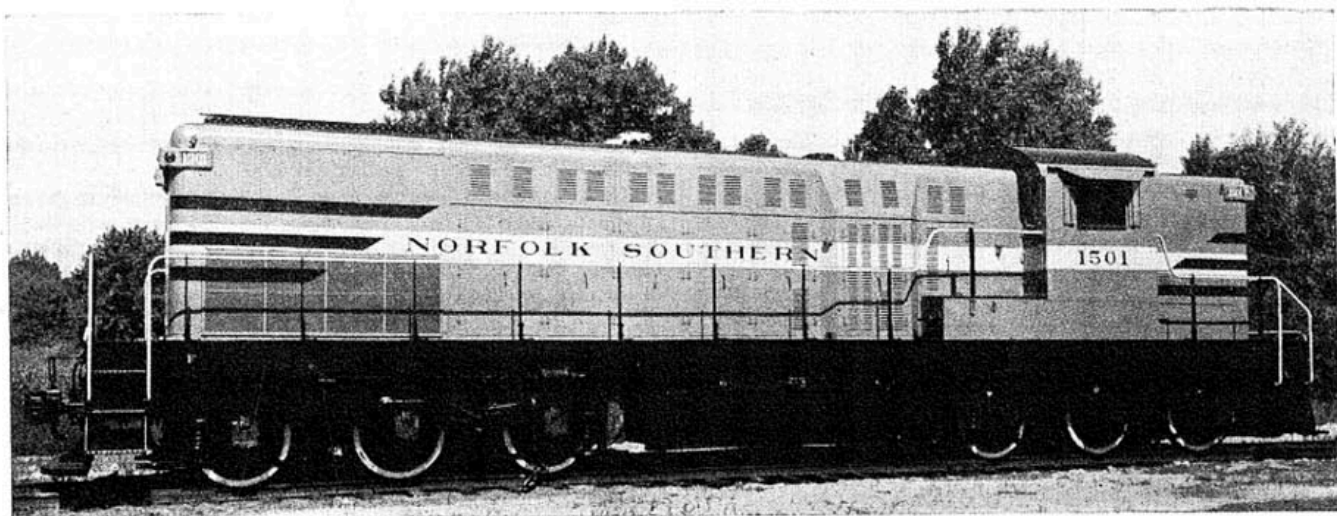
Fig. 9. — Locomotive Diesel-électrique Baldwin 1 500 ch du Norfolk Southern Railway.
