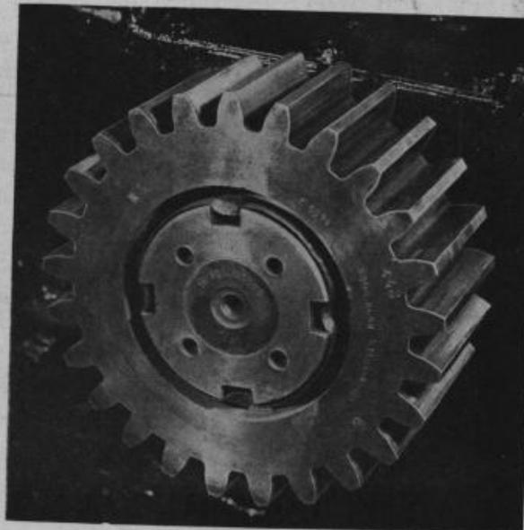
Fig. 31. — Etat de la denture d'un pignon de moteur au moment de la revision générale.
